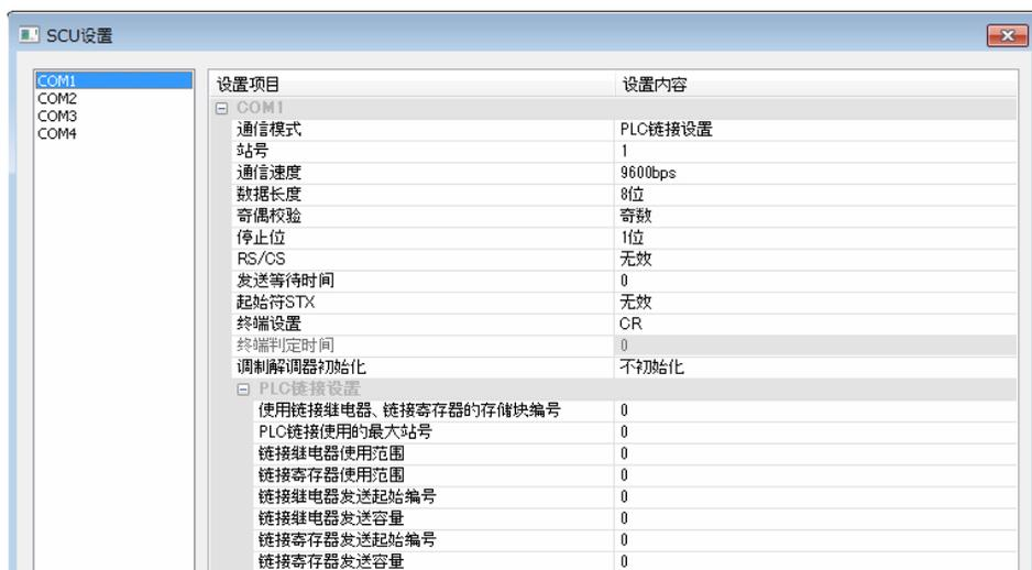
5. 对“PLC 链接设定”的各项设定需分配的条件，点击[OK]按钮。
